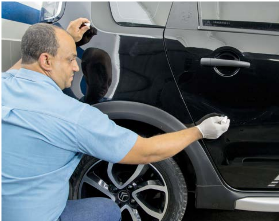
Reparo de arranhões sem uso da pintura convencional
