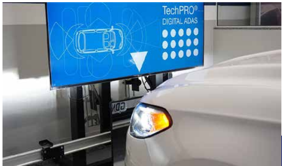
Equipamento de recalibragem ADAS em uma das lojas Autoglass
